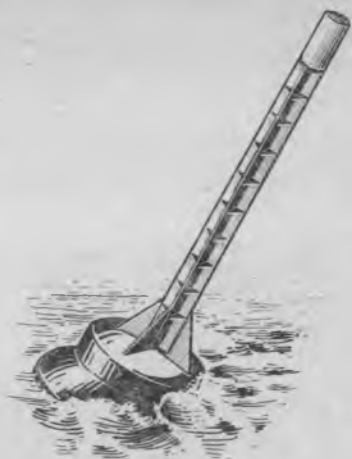
Рис. 19. Веха со спиральным радиолокационным отражателем
