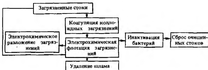
Рис. 6.34. Последовательность процессов электрохимической обработки сточных вод.
