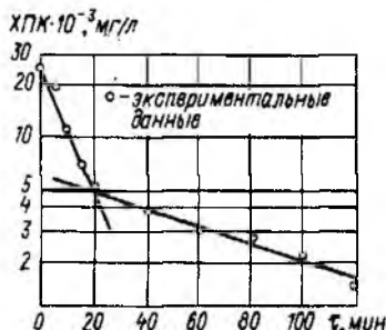
Рис. 6.37. Зависимость изменения логарифма ХПК сточных вод от времени для установки „Пуритек“.
