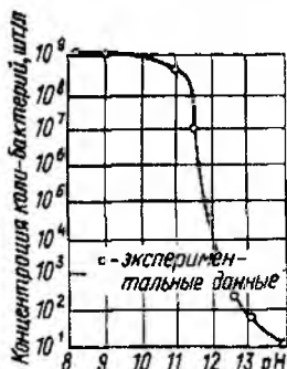
Рис. 6.36. Зависимость степени обеззараживания воды от pH .
