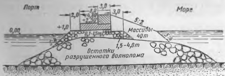
Рис. 67. Профиль восстановленного волнолома
