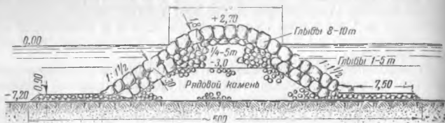
Рис. 70. Профиль Северного мола
