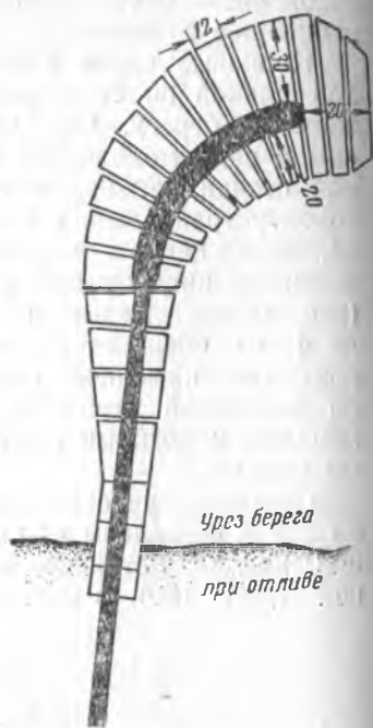
Рис. 152. План фашинной постели под молотом
