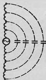
Рис. 5. Распределение индуктивности и емкости в симметричном вибраторе
