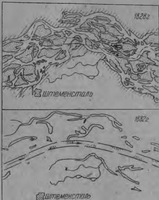
Рис. 28. Регулирование верхнего Рейна параллельными незатопляемыми дамбами.
