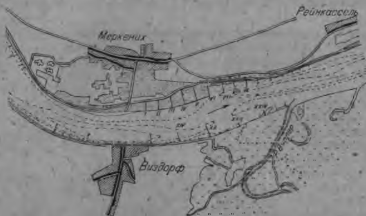
Рис. 98. Выправление Меркенихского пережата на Рейне.
