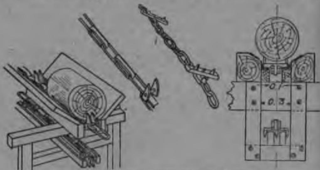
Рис. 309. Типы цепи и лотка продольной лесотаски.
