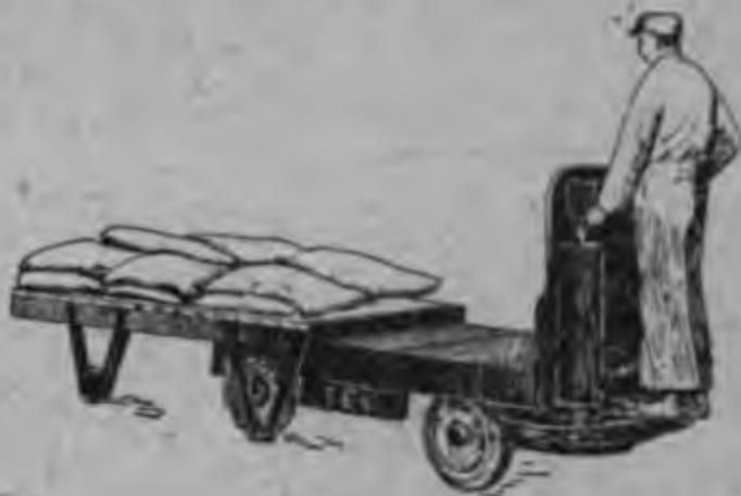
Рис. 89. Аккумуляторная тележка с подъемной платформой.
