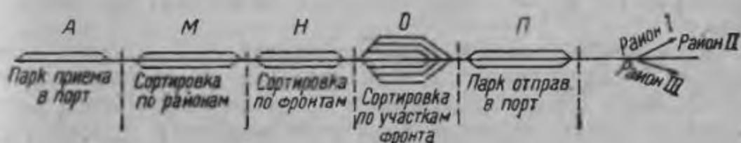
Рис. 25. Схема последовательного расположения парков предпортовой ж.-дор. станции.
