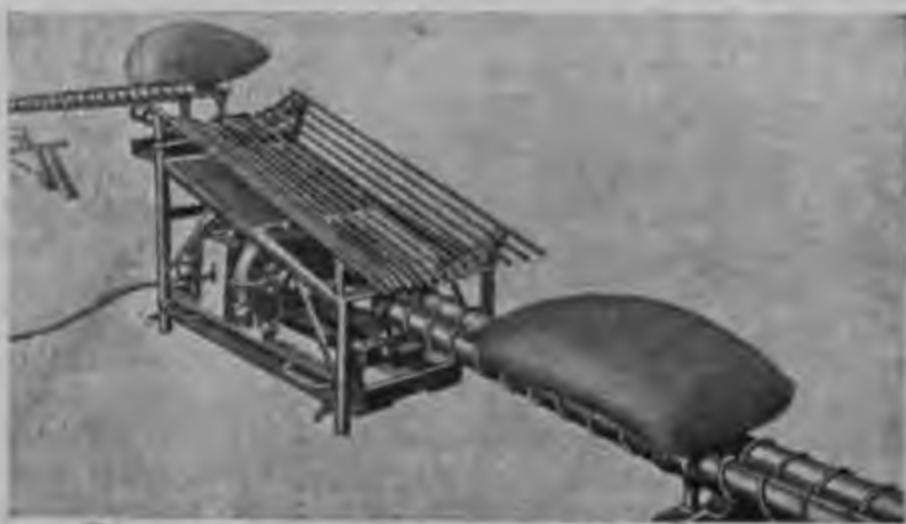
Рис. 68-а. Спиральный транспортер «твинвейер» для штучных грузов (общая установка).
