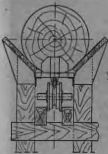
Рис. 310. Поперечный разрез продольной лесотаски.
