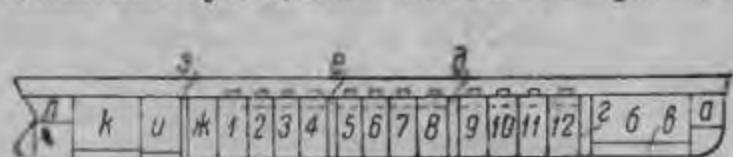
Рис. 360. Тип наливного судна (танкера).
