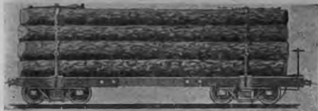
Рис. 321. Перевозка круглого леса на спец. ж.-д. платформе.
