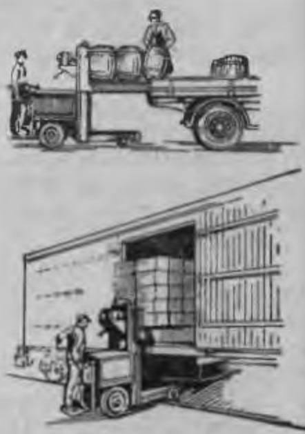
Рис. 107. Аккумуляторная тележка с высоким подъемом-платформой.
