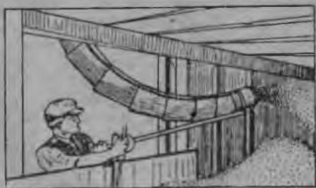
Рис. 178. Погрузка зерна самотеком из склада (элеватора) в вагон.
