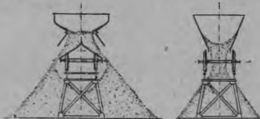
Рис. 269. Схема выгрузки навалочного груза из жел.-дор. вагонов на эстакаде.
