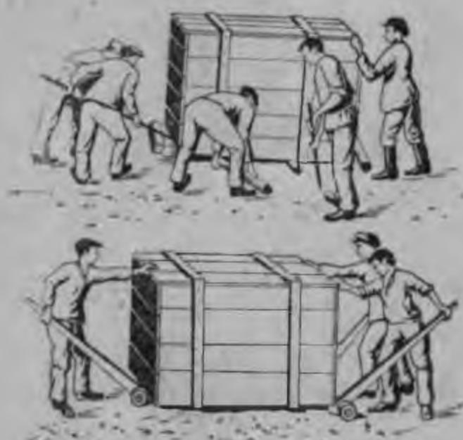
Рис. 16. Прежний и современный методы погрузки тяжеловесов.
