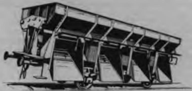
Рис. 205. Тип вагона с опрокидывающимся днищем.
