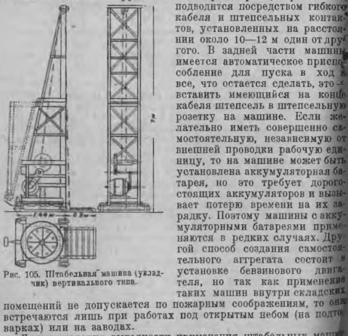
Рис. 105. Штабельная машина (укладчик) вертикального типа.
