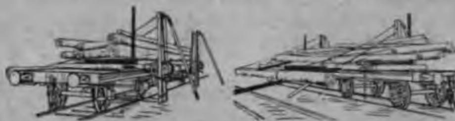
Рис. 319. Станок с ручной лебедкой для погрузки и выгрузки леса с жел.-дор. платформы.
