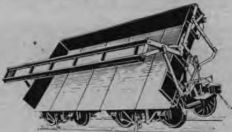
Рис. 204. Общий вид вагона с опрокидывающимся кузовом.
