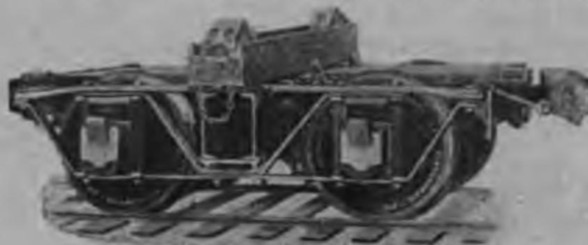
Рис. 320. Поворотная поперечина на жел.-дор. платформе для облегчения операций с лесом.
