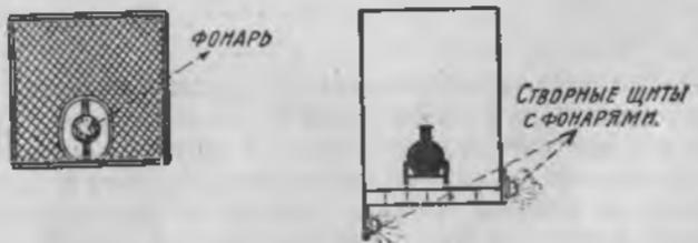
Обычный вид решетчатого щита, устанавливаемого на ферме моста для обозначения ходового пролета. Размер  $2 \times 2$  м.
